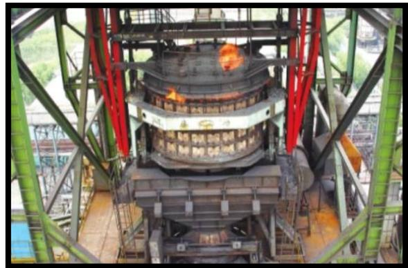
煤焦化工分公司干熄焦系统在密闭的干熄槽内冷却红焦，降低熄焦操作对环境的污染，干熄焦率可达到96%。
