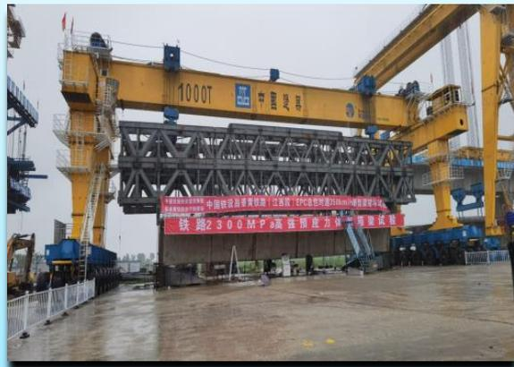
铁路 2300MPa 高强预应力体系箱梁试验
